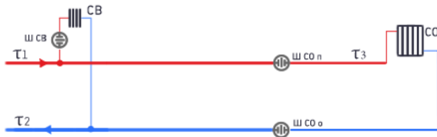
Рисунок 1.4.4 - Схема присоединения потребителей отопления непосредственная зависимая
