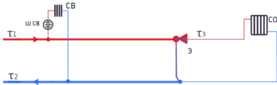
Рисунок 1.4.3 - Схема присоединения потребителей отопления по зависимой схеме через струйный насос
