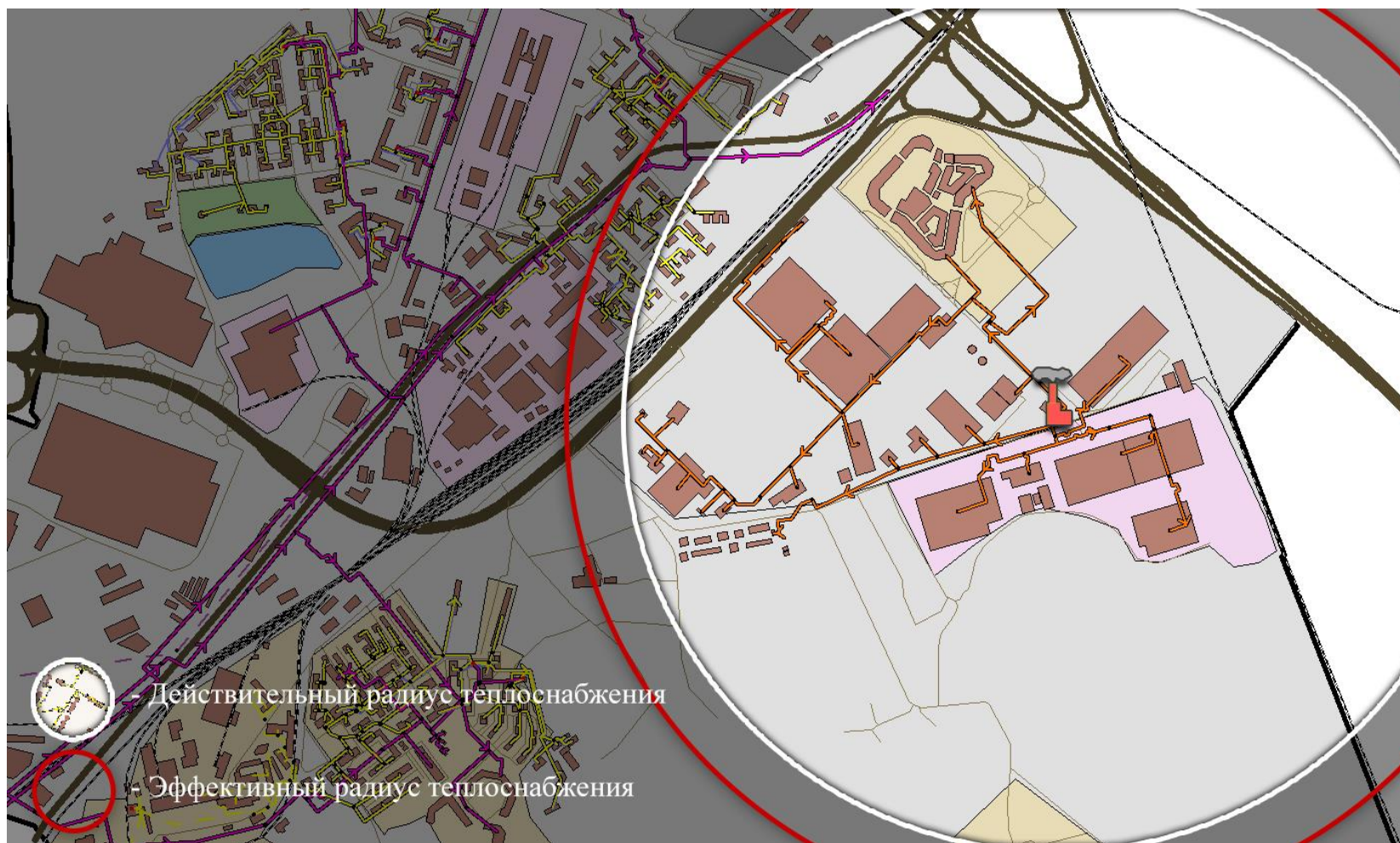
Рисунок 6.1 - Действительный и эффективный радиусы теплоснабжения котельной АО «Белая Дача Инжиниринг»
